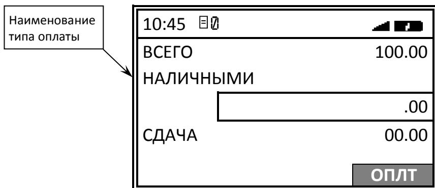
В случае если необходимо вернуться к выбору другого типа оплаты следует нажать клавишу **[C]**, затем повторить пункты 5 – 9. Для закрытия чека типом **НАЛИЧНЫМИ** – нажать клавишу **[Ввод/=]**.
