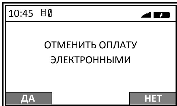
Для отмены оплаты типом ЭЛЕКТРОННЫМИ необходимо нажать на клавишу **[F1]** под словом **ДА**, ККТ вернется в режим оплаты и на дисплее отобразится информация с наименованием типа оплаты **НАЛИЧНЫМИ**, запрограммированным в ККТ по умолчанию:
