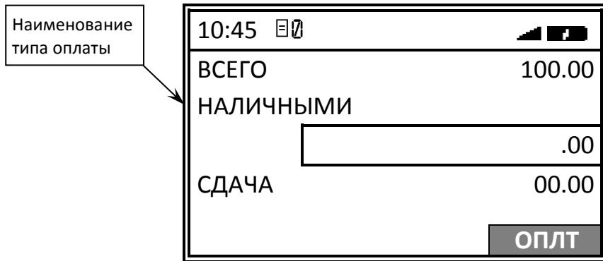
При необходимости отменить оплату ЭЛЕКТРОННЫМИ, следует нажать клавишу [C], и вернутся к выбору типа оплаты, затем повторить пункты 5 – 9. Для закрытия чека – нажать клавишу [Ввод/=].
